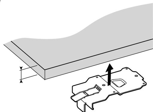
**ATTENZIONE:** elementi di fissaggio di montaggio non sono inclusi con staffa. Utilizzare dispositivi di fissaggio appropriati per collegare a una superficie solida montaggio in grado di supportare 50 kg (23 kg). Come minimo, la superficie di montaggio dovrebbe essere legno spessa 1/2" (1,25 cm) e montare utilizzando 4 viti di legname metalliche (M4 x 12 mm).
