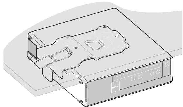
La staffa di montaggio Dell OptiPlex 780-USFF sostiene il sistema con orientamento verticale o orizzontale.
