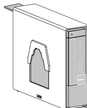
4 Spingere il porta etichetta del sistema nella custodia del sistema, quindi portare il cursore in posizione di bloccaggio.
