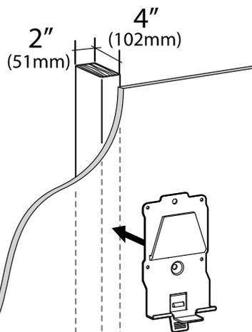
**ATTENZIONE:** i dispositivi di fissaggio forniti sono indicati per l'uso con assi in legno da min. 51 x 102 mm. Verificare con un esperto i dispositivi di fissaggio più indicati in base al materiale della superficie e al carico applicato.
